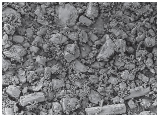
Obrázok 1 - Častice síranu vápenatého, \alpha -hemihydrát
