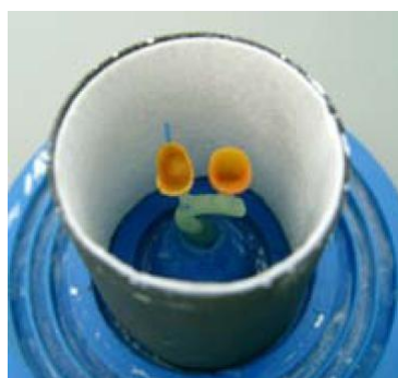
Obrázok 15 - Príprava lejúcej obráčky/kyvety
