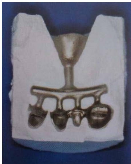
Obrázok 19 - Perfektný odliatok je výsledkom správneho postupu
