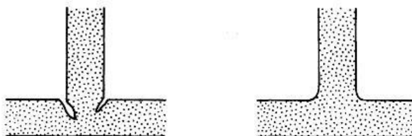
Obrázok 9 - Prechod medzi lejúcim kanálkom a voskovým modelom (vľavo nesprávne, vpravo správne)
