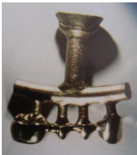
Obrázok 20 - Porozity môžu byť v sústave kanálikov, samotný odliatok musí byť bezchybný
