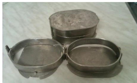
Obrázok 22 - Štvordielne kovové kyvety
