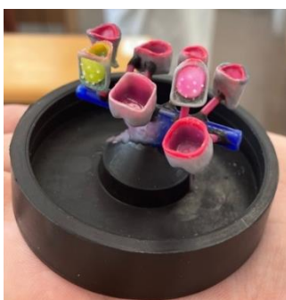
Obrázok 14 - Príprava lejúcej obráčky/kyvety
