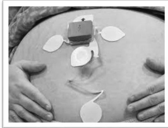
Obr. 3. 56 Bezdrôtový fetálny monitoring Novii Wireless Patch System (Zdroj:Smith, L., 2019)
