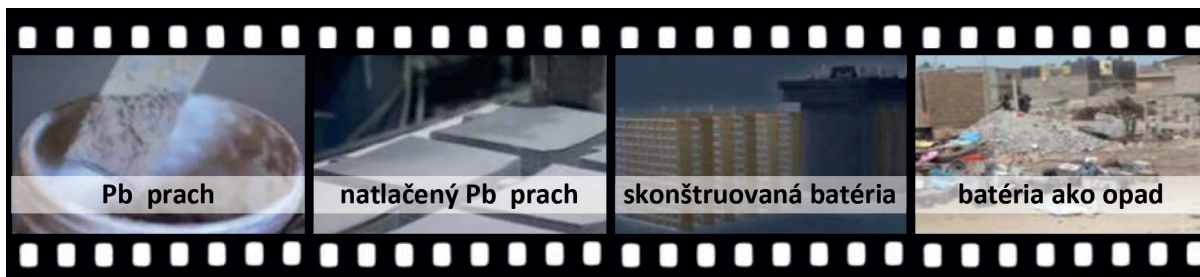
Obrázok 24 – schematický náčrt životného cyklu akumulátorovej batérie v 4 etapách:
